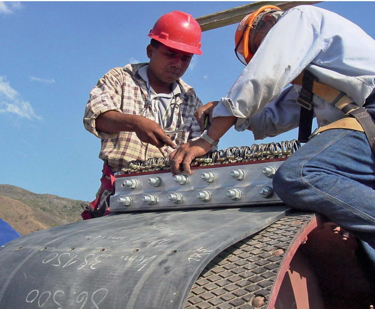
ベルトの補強コードのスライシング
