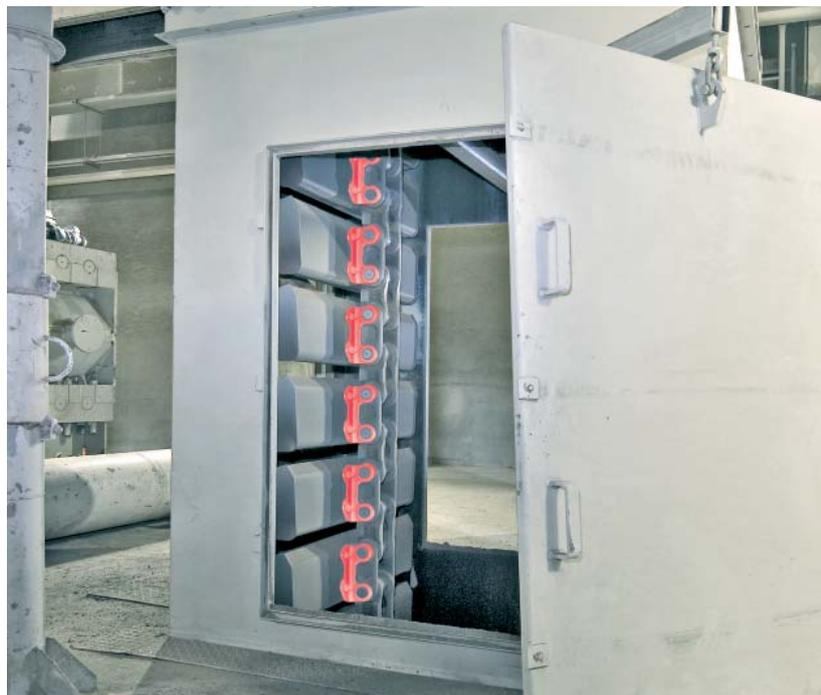
容易なメンテナンス作業のための、ヒンジサポートのドアを装備した組立て構造のケーシング
