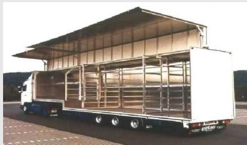
トラックの上部構造には、15,0m長さまでの高さのパネル
