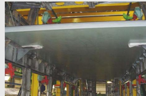
独立した中間床のダブル・デッキ・ワゴン、鉄骨構造、さねはぎ結合部 (寸法 2,64 x 8.09 m)
