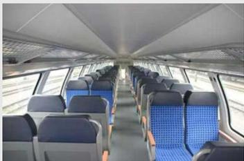
内装部品: 天井とメンテナンス・ハッチ、分離壁、フロア・パネル、階段パーツ、階段周辺部等
