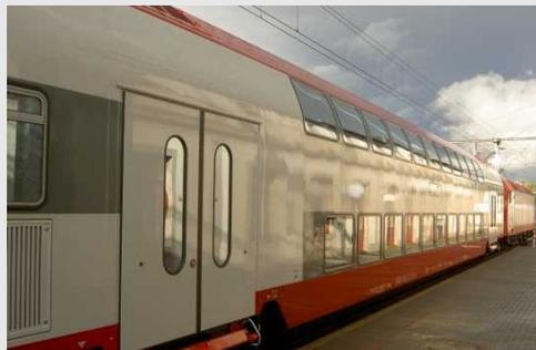
独立した中間床のダブル・デッキ・ワゴン (寸法 2,61 x 15,46 m), 一枚のアルミニウム構造
