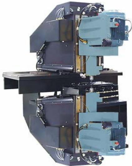
•Friction Stir Welding (FSW): 摩擦溶接方式は特殊形状回転ツールを使用し2つの部品を溶接する技術です。 ツールの回転圧力摩擦により摩擦熱を発生させ部品を金属の融解点以下で塑性域で回転ツールのエリアで溶接する技術です。
