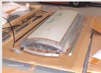
オープン炉又は高圧蒸気養生用の金属金型
