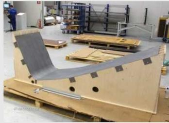
オープン硬化135°C用のサンドイッチ部品ツール
