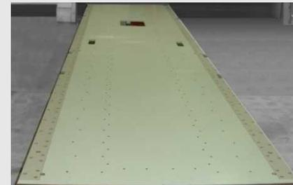
鉄道インフラに適合した設計で、また火花から延焼を保護するための接合点を擁した組立前の完成屋根パネル (寸法: 2,41 x 10,34 m)
