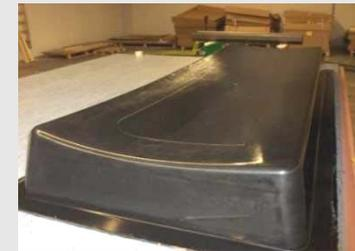
オープン炉又は高圧蒸気養生によって作られるパーツ用のRI-金型
