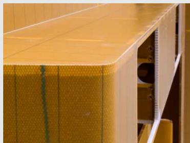
航空機内装用組立の細部 (EC社によって基礎構造は完成)
