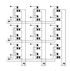
生しません。一般的に、2nペアのワイヤがあれば、n²個の測定点を接続することができます。このため、配線、制御用電子部品、評価用電子部品の複雑性については、一次式的な増加ですみます。このようにして、任意のサイズの大型燃料電池を簡単に製作することができるのです。
