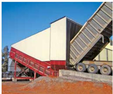
ダスト引き抜き装置が無い、フレキシブルエントリーカーテンを装備した完全密閉仕様
