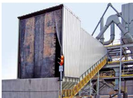
貯蔵量又は吐出高さを増加させるための伸長した傾斜部
