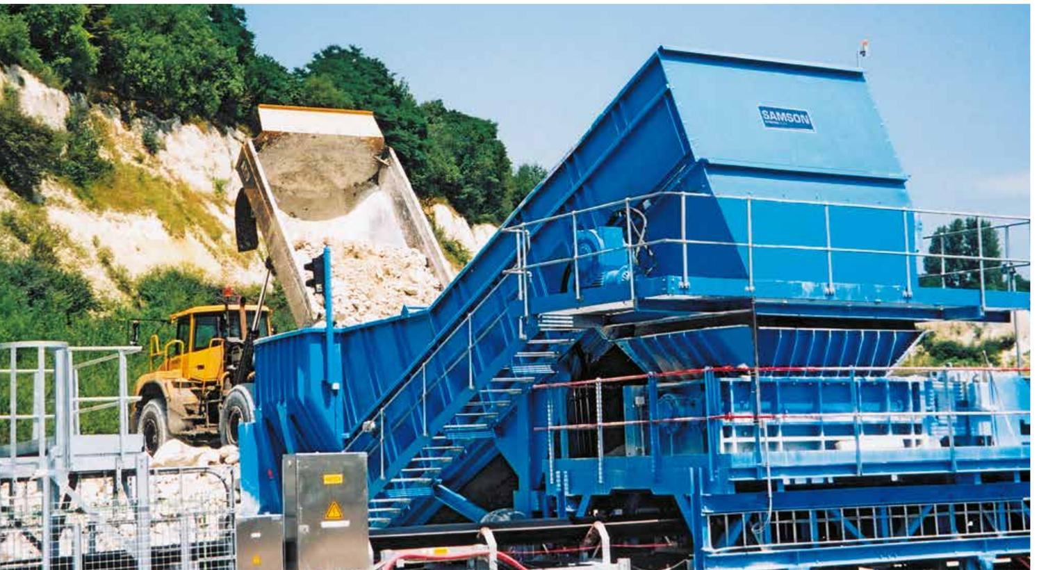
採掘した状態の石灰石をダンプトラックから受け入れ、後続のコンベアーに適切な粒径で受け渡す、ツインシャフト回転サイザーを装備したSamson®マテリアルフィーダー
