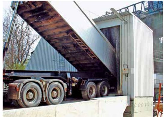
既設のコンベアーに輸入したセメントクリンカーを直接受け入れる、側部投入仕様のSamson®マテリアルフィーダー
