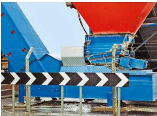
急勾配のベルトコンベアーへの吐出量を制御する振動型フィーダー
