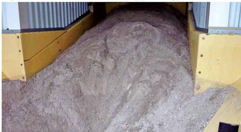
このSamson®マテリアルフィーダーは、粉碎した石灰石の受け入れ設備での小型化によるソリューションを実現しております。石灰石は10マイル離れた現地の砕石場から、折り返し輸送によりトラックで運搬されます。トラックによる迅速な運搬を実現するこの柔軟なソリューションは、土木工事の手間を最小限なものとしします。
