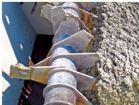
水分量の多い粘土を取り扱う回転ティーザー、吐出量を綿密に制御
