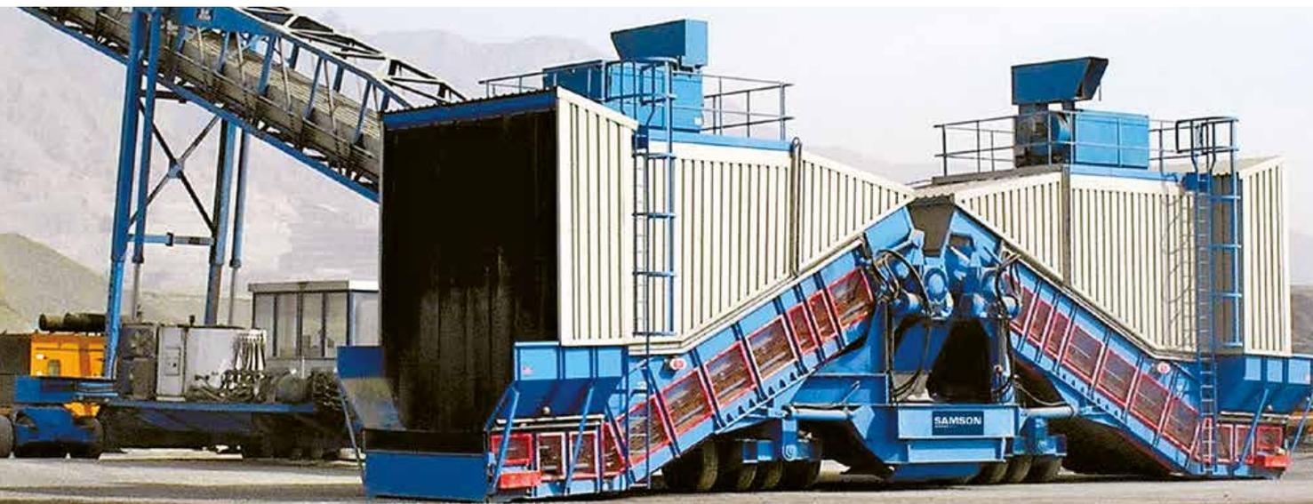
移動型シップローダーと一体化した、完全ダスト制御を備えたツインSamson®マテリアルフィーダーによる、トラックから船舶へのダイレクトなバルク輸出
