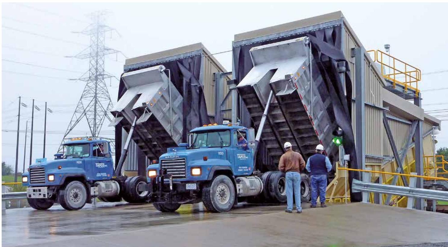
アメリカのアメリカン発電所の排ガス脱硫システム用に、25mmアンダーの石灰石を受け入れるツインSamson®マテリアルフィーダー
