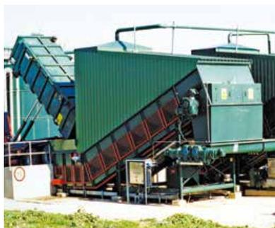
悪臭の発生がある物資用に引き抜き装置を装備したエンクロージャー
