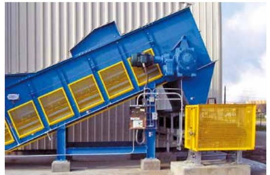
水平ベルトコンベアーへの合成石膏の吐出
