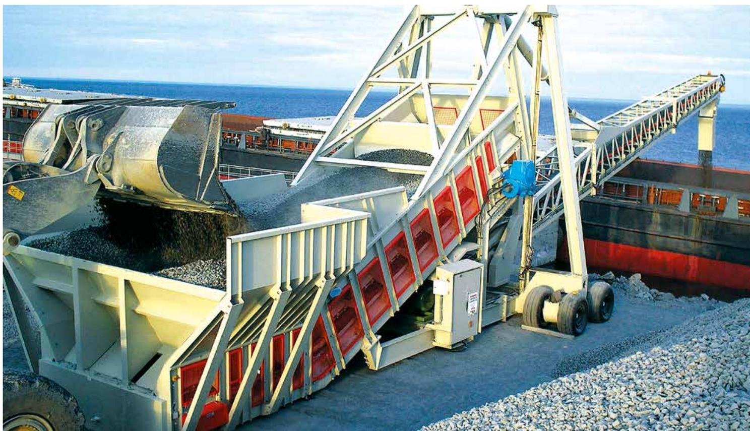
斑レイ岩をショベルより受け入れ、1,000 tphの能力でバージに積み込む大型のSamson®マテリアルフィーダー MF16xxx
