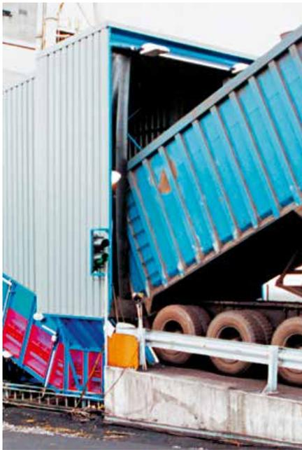
横幅の広いエプロンベルトの設計により積載貨物の高さが低くなり、トラックは短いアクセス用ランプを使って、エントリー部へ直接貨物を投入する事ができます。
