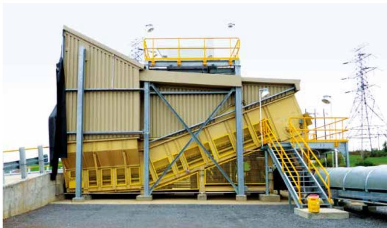
Samson®マテリアルフィーダーの高さのある吐出部により、地表部に設置されたベルトコンベアーへの直接投入が可能
