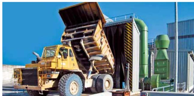
大型の採掘ダンプトラック用にフレアエントリ一部を大型化したエンクロージャー
