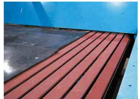
荷重をサポートする鋼製エプロンバー
