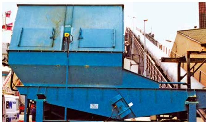
傾斜型ベルトコンベアーへの制御吐出を行う振動型フィーダー
