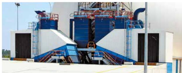
ドーム型貯蔵への垂直エレベーターに装備されたツイーンSamson®側部投入型フィーダー
