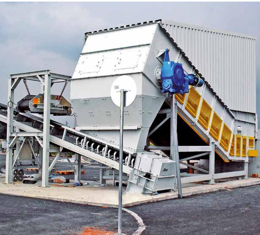
傾斜型ベルトコンベアーに接続する、ティーザー吐出機構を装備した Samson®マテリアルフィーダー
