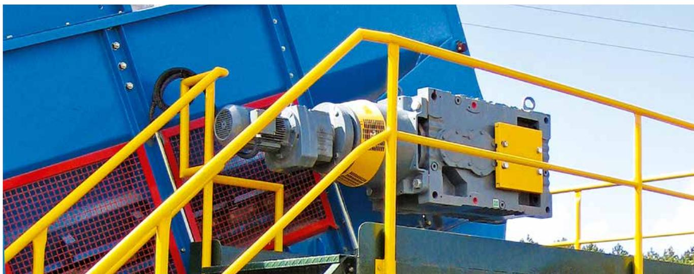
螺旋構造を持つ高効率のヘリカル/ベベル型メイン減速機
